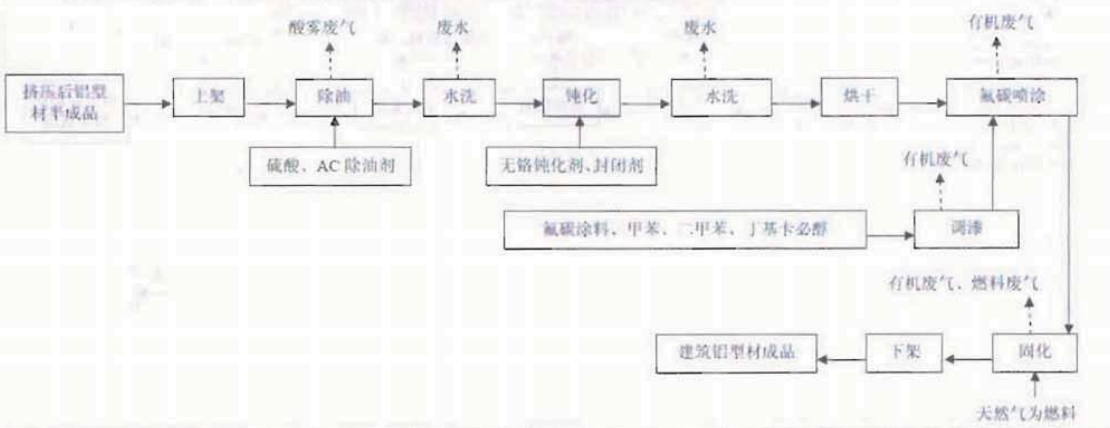
(6) 氟碳喷涂生产线工艺流程及产污节点图
