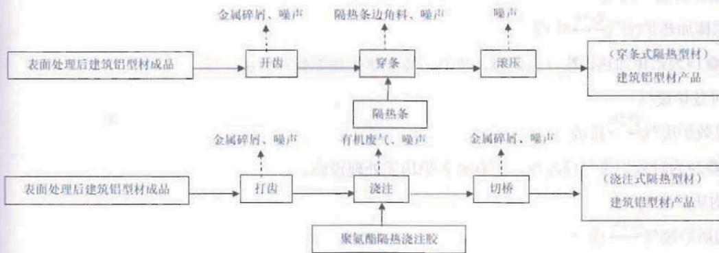
(8) 隔热型材生产线工艺流程及产污节点图
